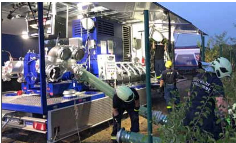
Nur einen Monat nach der Auslieferung kommt die neue Großpumpe des THW Riesa im August 2018 zu ihrem ersten Einsatz. THW-Helfer aus den Ortsverbänden Bautzen, Kamenz, Radebeul und Riesa fluten ein 10.000 Quadratmeter großes unterirdisches Kohlestaubbecken, um einen tief eingedrungenen Brand zu bekämpfen. (Fotos: Martin Werner)
