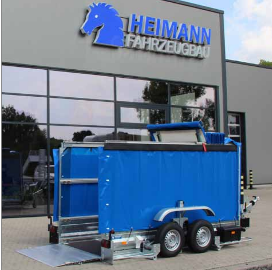
Ein Vergleichsmuster der Firma Heimann: mit Rampe, Schiebplane rundum und absenkbar – so könnte der neue Anhänger 2t für die Logistik Materialerhaltung aussehen.
