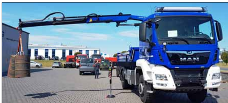
Fahrgestell und Motorisierung sind identisch, aber große Kabine und lange Pritsche beim Kipper Räumen, kleines Führerhaus, Ladekran und kurze Ladefläche beim Kipper Logistik.
