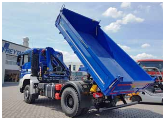
Fahrgestell und Motorisierung sind identisch, aber große Kabine und lange Pritsche beim Kipper Räumen, kleines Führerhaus, Ladekran und kurze Ladefläche beim Kipper Logistik.
