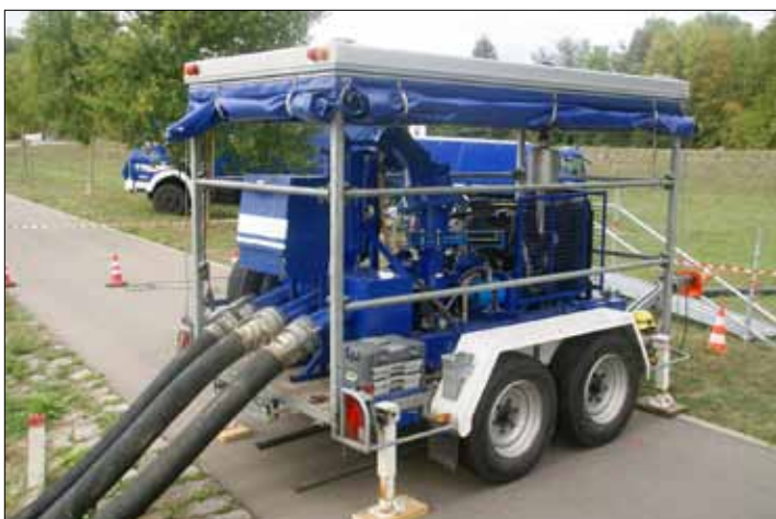
Die DIA mit einer Leistung von 15.000 l/min ist das Herzstück der Pumpenausstattung in Offenburg. Der Anhänger war schon in den USA im Einsatz.
