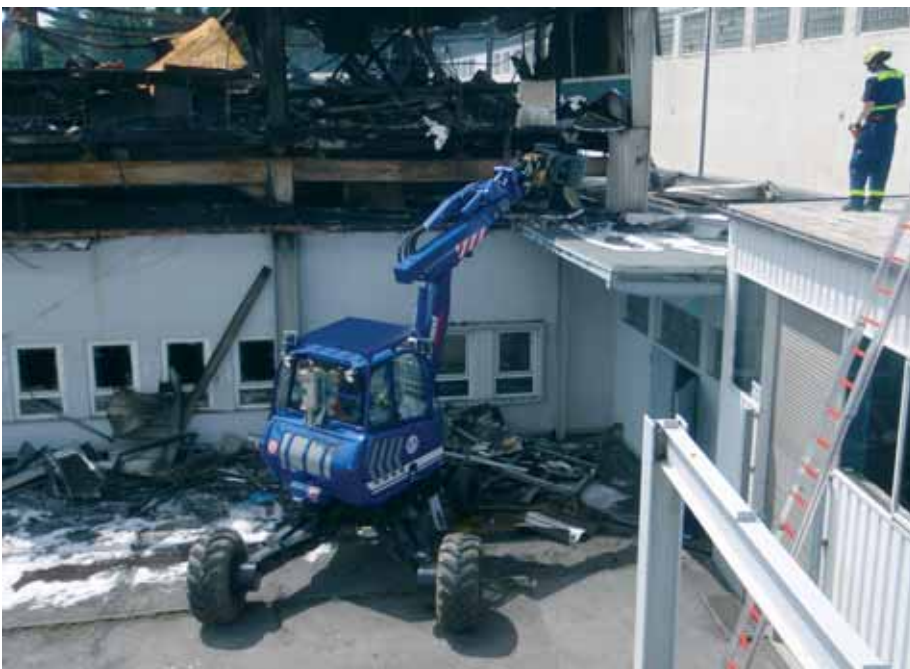
Ein Brand in Remscheid ist der erste Einsatz für die neue Rettungsspinne. Dank Fernbedienung kann das Gerät von jedem Punkt aus gefahrlos gesteuert werden
