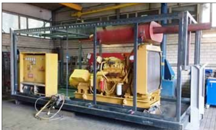
Ein Notstromaggregat in einem 20-Fuß-Container haben die THW-Helfer aus Cloppenburg in einen Abrollbehälter Netzersatzanlage umgebaut. Zum Transport wird der Wechsellader der Fachgruppe Ölschaden verwendet.
