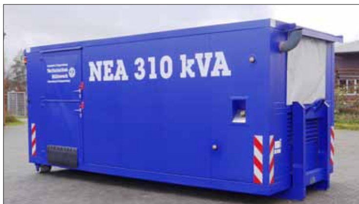
Ein Notstromaggregat in einem 20-Fuß-Container haben die THW-Helfer aus Cloppenburg in einen Abrollbehälter Netzersatzanlage umgebaut. Zum Transport wird der Wechsellader der Fachgruppe Ölschaden verwendet.
